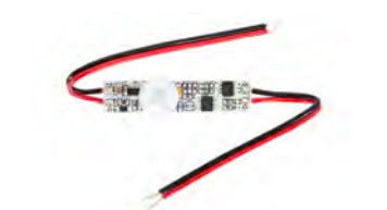
Ref. 83188 12V 36W/24V 72W MAX Mini sensor de movimiento
